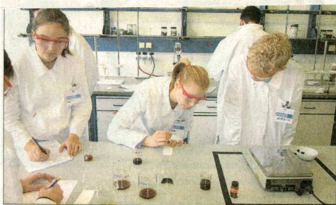
Auftragen der Koffeinproben für die DC - Chromatographie
